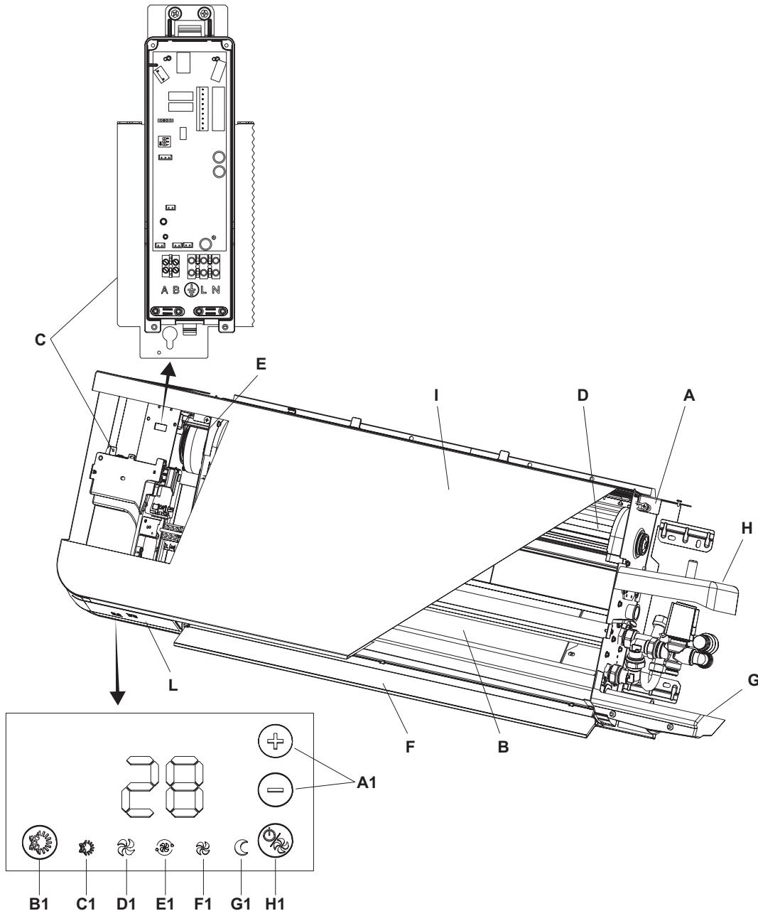
**A - Estructura portante** de chapa electrocincada de alta resistencia.
