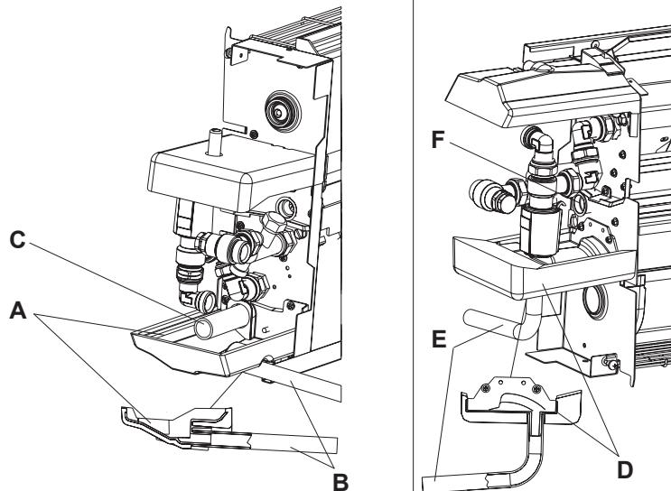
**Montaje del dispositivo de descarga de la condensación en la versión elevada**
