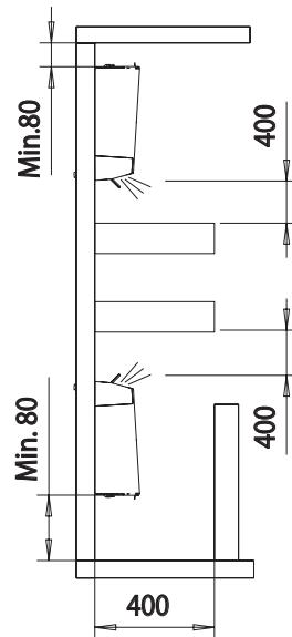
El aparato debe ser instalado en una posición que permita realizar fácilmente las operaciones de mantenimiento ordinario (limpieza del filtro) y extraordinario, así como el acceso a las válvulas de purga de aire (batería y panel), que pueden ser alcanzadas a través de la rejilla superior (en el lado de las conexiones).
